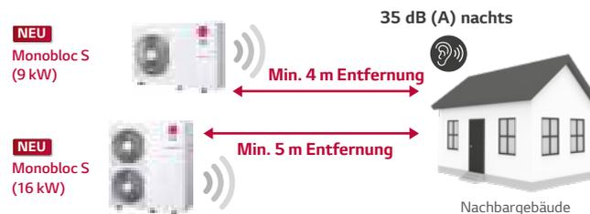
\* Der Schalldruckpegel wird vom Schallleistungspegel des geräuscharmen Modus auf der Grundlage eines Zuschlags für Tonhaltigkeit von 0 dB und der Installation im Freifeld umgerechnet.
